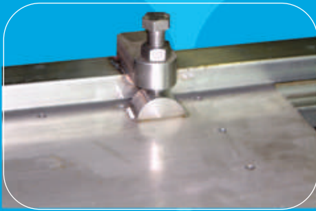
| Detalle del sistema de cuñas para cierre a 4 caras |
